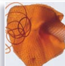
ゴム Rubber 国際規格(INT)によるリブド・スモークド・シート3号(R.S.S.No.3)
